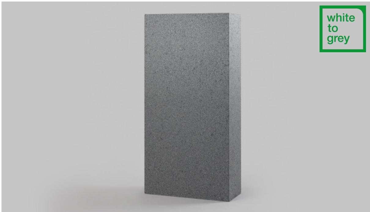
Sundolitt Climate C80 är skivor tillverkade av expanderad polystyren med tillsatt grafitstoff och används som isolering i grund, prefabväggar och kombinationstak. Det tillsatta grafitstoffet reflekterar och absorberar infraröd värmestrålning vilket innebär att Climate C80 minskar värmeförlusterna med upp till 25% jämfört med vit EPS.
