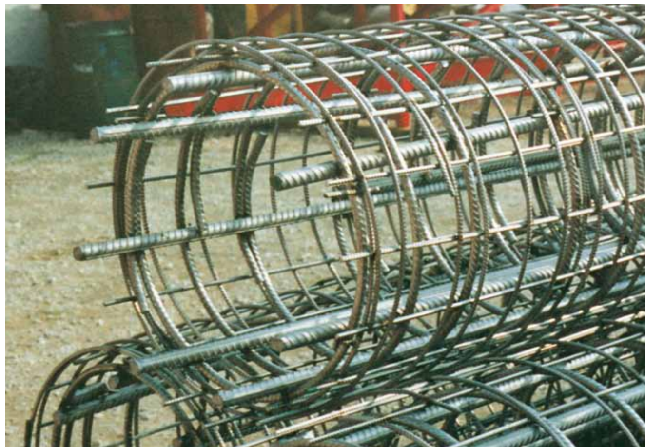
Svetsade pelarkorgar i rostfritt används med fördel där konstruktionen utsätts för t ex vägsalt, stora temperaturvariationer och mekanisk nötning.
