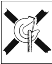
Kuva 4 a Silmukka kuormittaa koukun kärkeä!
