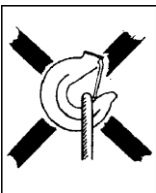
Fig 2 a Slinget belastar krokspetsen!
