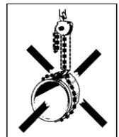
Fig 2 e Lastkättingen får ej användas som sling!
