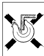
Fig. 2 d Krokspissen i tillegg utsatt for bøyningspåkjenning!
