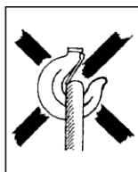
Fig. 2 c Kroksperrern blokkert!
