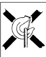
Fig. 2 a Slyngen belaster krokspissen!
