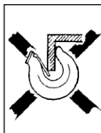
Kuva 2 d Koukun kärkeen vaikuttaa lisäksi vääntävä kosketusrasitus!
