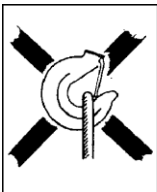
Fig. 2 a Slyngen belaster krokspissen!
