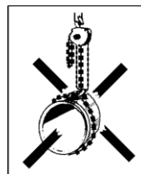
Kuva 2 e Kuormaketjua ei saa käyttää silmukkana!
