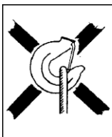
Kuva 2 a Silmukka kuormittaa koukun kärkeä!
