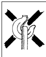
Fig 2 c Krokspärren blockerad!
