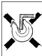
Fig 2 d Krokspetsen dessutom utsatt för böjpåkänning!
