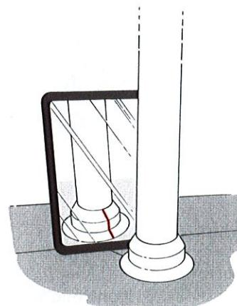
7. Kontrollera att skarven är bra, och att **lite** lim har "vulkat" ut under stosens tå, runt om.
