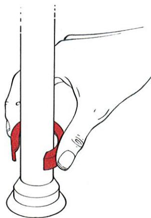
5. Fixera skarven med klämman. Vänd klämmans öppning från väggen.
