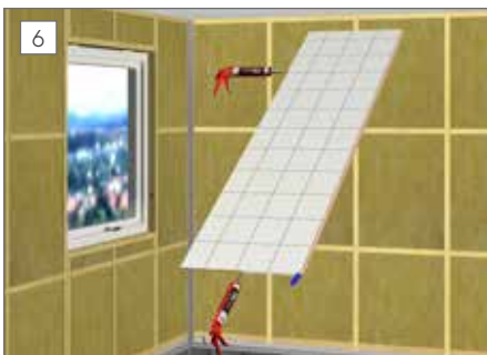
6 Påför godkänd fogmassa på sågade ytor. Se bild. Dra ut fogmassan med fogkloss.
