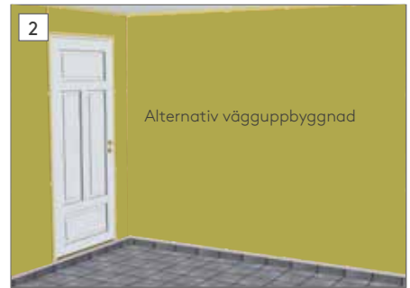
2 Alternativ vägguppbyggnad För bästa resultat använd minst 12mm byggplywood bakom skivorna. OBS! om klinker ska sättas mot väggen måste en godkänd skiva monteras minst 200mm upp från golvet. Om golvet läggs med våtrumsmatta skall mattan upp minst 150mm på väggen. Se monteringsanvisning för klinker/plastmatta.
