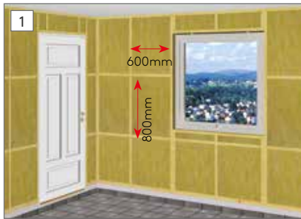
1 Skivorna ska förvaras liggande i originalförpackning minst 3 dygn innan montering för att aklimatiseras. Skivorna monteras på befintlig skruvfast vägg eller på regelverk c/c 600mm med kortlingar c/c 800 mm. Om tunga föremål ska hängas upp måste dessa ha kortlingar
