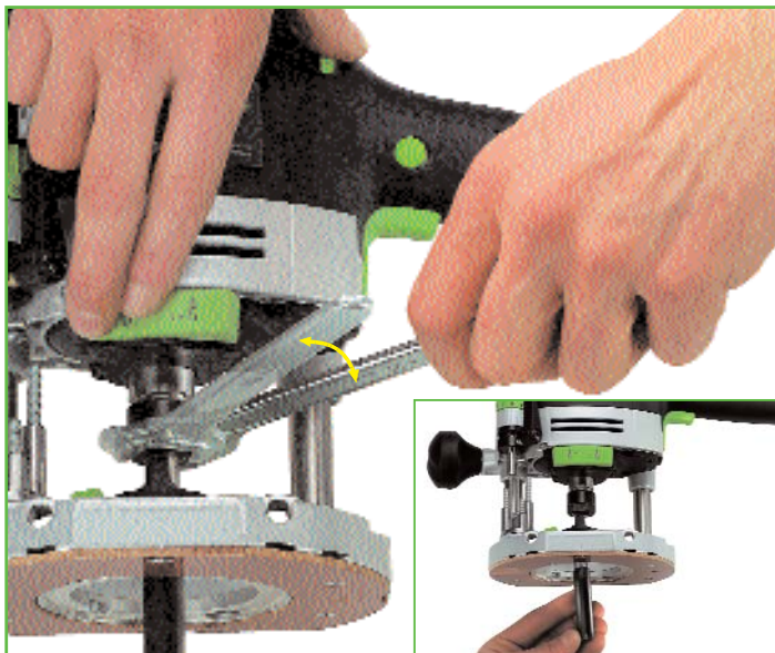
Tack vare spärrnyckelsfunktion byter du fräs bekvämt, snabbt och säkert.
